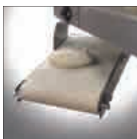
Разгрузочная турель Поворачивается на 180° для создания конфигурации с тестоформочной машиной, находящейся снаружи.
